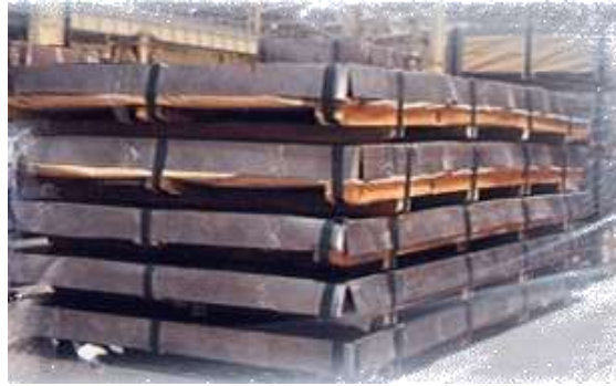
Gambar 4. 17 Hasil akhir produksi Cold Rolling Mill Plant Berupa CRS ( Sumber : Data PT Krakatau Steel (Persero), Tbk. )
