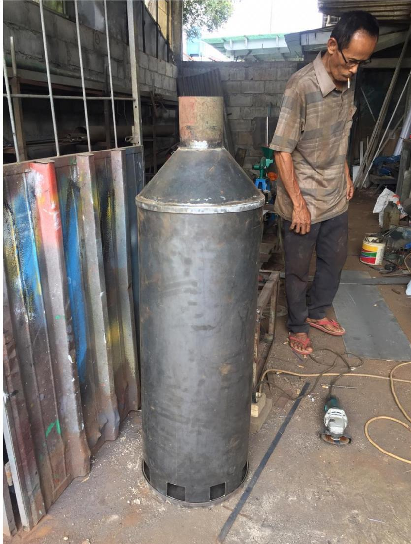
Proses pembuatan alat Drum Kiln
