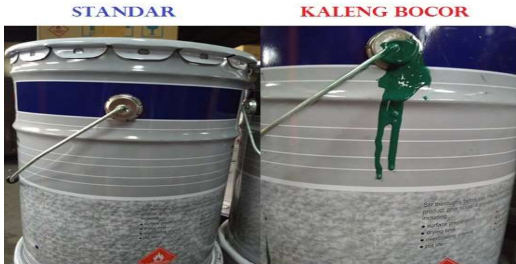
Gambar 4. 2.2 Kaleng Bocor pada Produk Cat Kemasan Pail 20L
