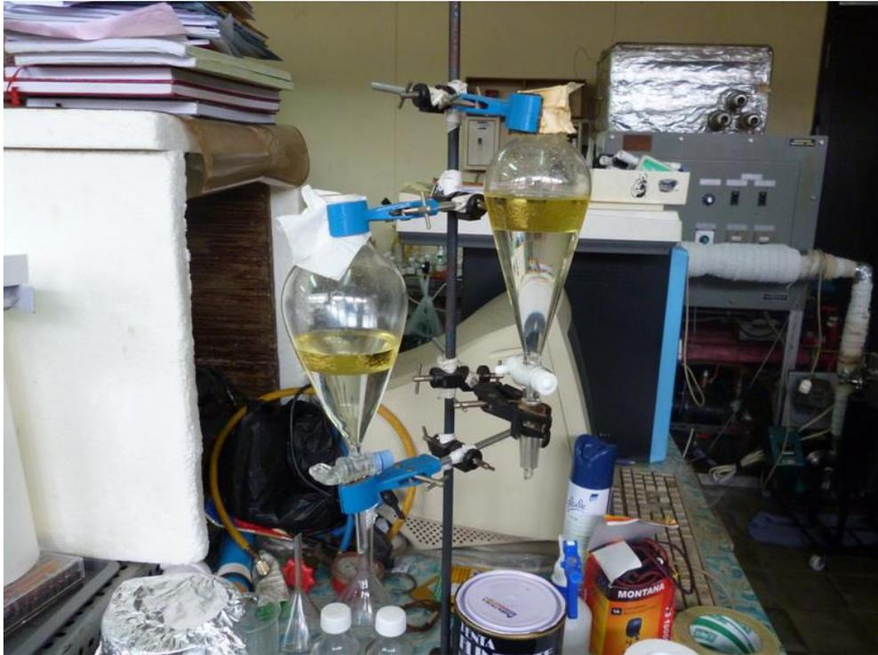
Proses pencucian biodiesel perlakuan 6 *static mixer* dan 8 *static mixer*
