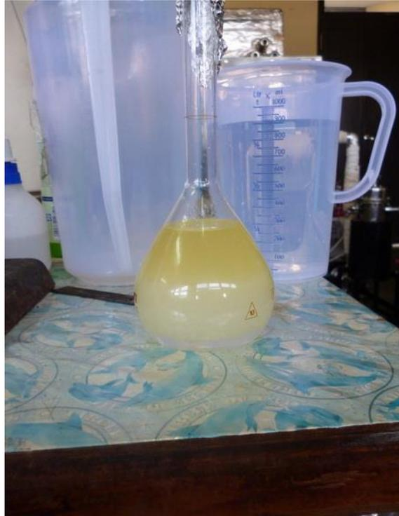
Proses pencampuran biodiesel dengan akuades
