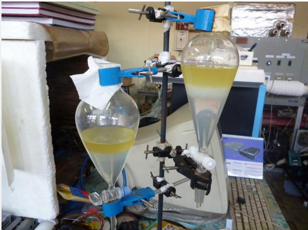
Proses pencucian biodiesel perlakuan 2 *static mixer* dan 4 *static mixer*
