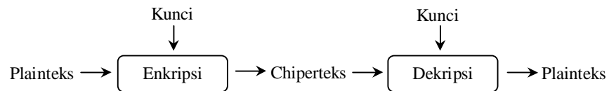
Gambar 2.2. Skema enkripsi dan dekripsi dengan kunci
